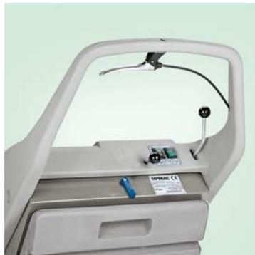
Mandos de funcionamiento: mando de apertura/cierre de la aspiración, sacudidor de filtro, levantamiento/bajada del cepillo lateral, mando de avance de la máquina (en los modelos con tracción)
